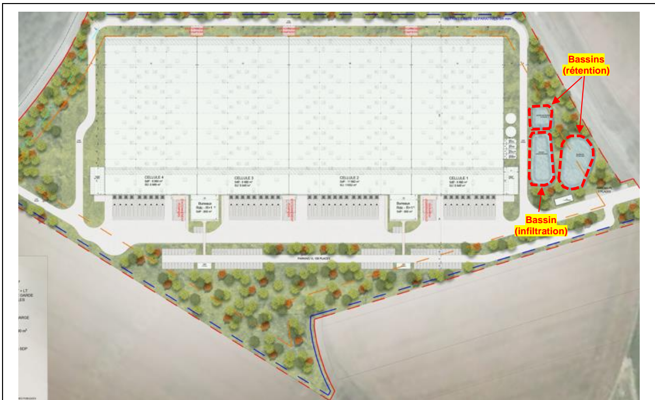
Figure 9 – Localisation des bassins de gestions des EP (en rouge) sur le plan de masse
